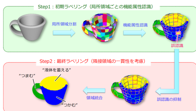
図 8. 仮ラベル統合による機能ラベリングの高信頼化
