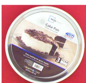
ケーキ皿 金属のためサチりやすく 3D センサでも撮影が困難
